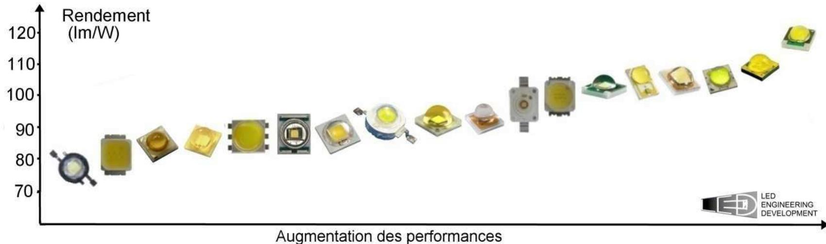
Rendement (lm/W) de quelques modèles de LED de puissance présents dans le commerce (neutre 4000K, à 350mA, modèles fabriqués en 2011-2012)
